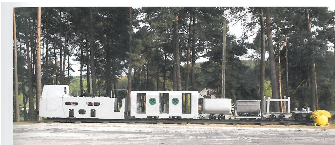
W procesie likwidacyjnym kopalni podziemnej o mały włos nie doszło do zniszczenia ostatniego jej świadectwa - składu pociągu. Zamiar udaremniłi górnicy dołowi. Ocalony zabytek górniczej techniki, zespólny z lokomotywy Ld1, wozu urobkowego, wozu do drewna, koleby i wózka technologicznego z przyrządem do gięcia szyn, ustawiono przed budynkiem administracyjnym Kopalni.
